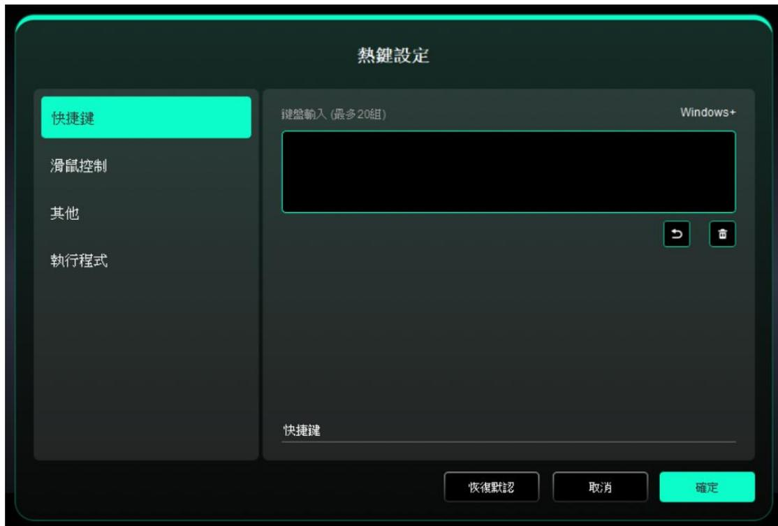
配置鍵盤快捷鍵，例如：在 3D MAX 軟體中設置為 “Alt+A” 可以使用對齊工具。
